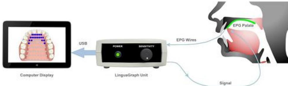
LinguaGraph determina el contacto lengua-paladar usando un paladar artificial especial que contiene 62 electrodos incrustados en su superficie lingual. Se envía una pequeña señal al usuario, la cual es conducida a través de la lengüeta a cualquier electrodo tocado. Estos patrones de contacto lengua-paladar se muestran a continuación en una pantalla de ordenador.
